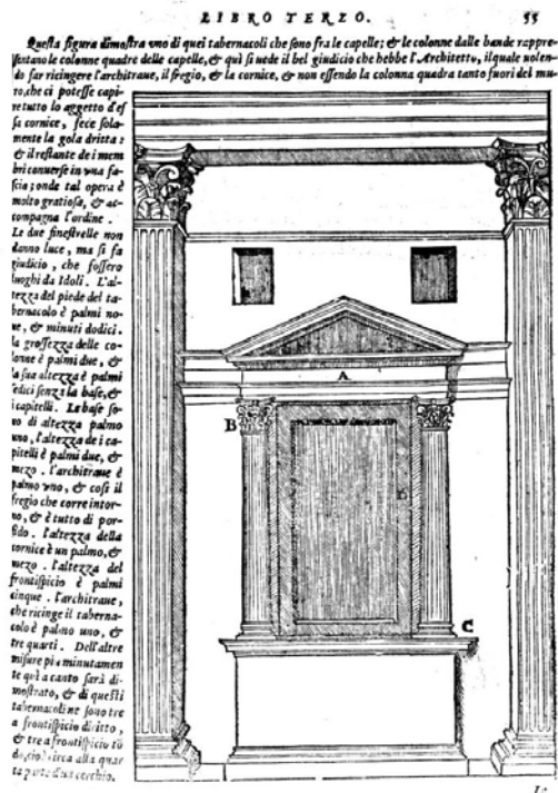
Livre III, fol. 55 r. Panthéon. Niche rectangulaire à fond plat dans un encadrement à édicule.
