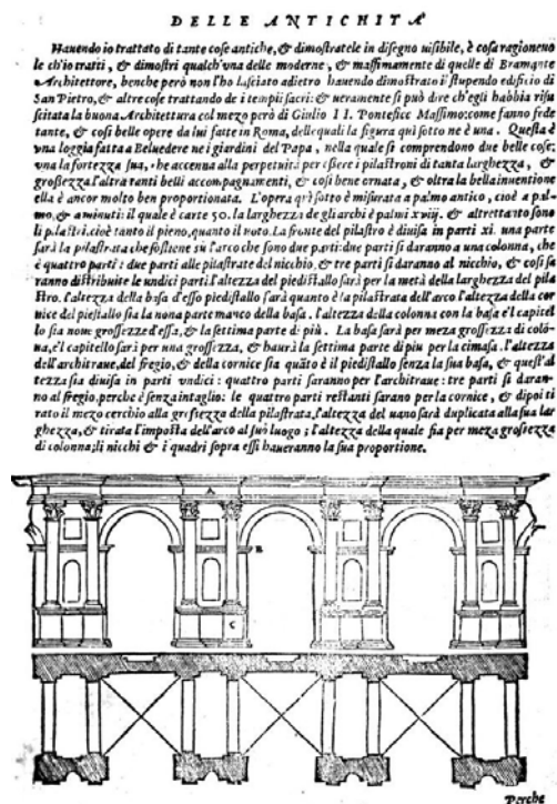
Livre III, fol. 117 v. Loggia du Belvédère. Niche et table rentrante dans l'entrecolonnement.
