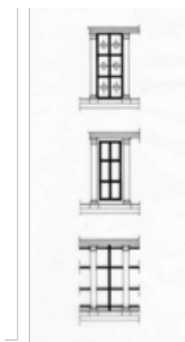
figure 9- Santa Maria Novella. a. détail de l'entrecolonnement du second niveau, b. panneau indépendant, c. panneau "passant"
